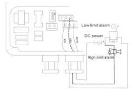
Fig. 3.4 (d) Alarm output wiring
